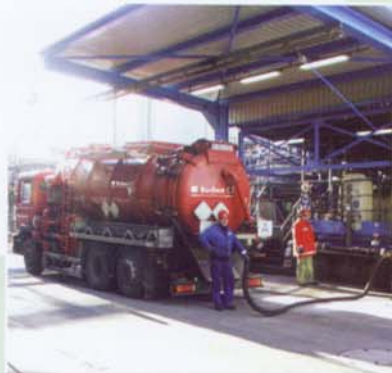
Flüssigabfallübernahme aus Saugwagen
